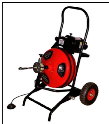
Рисунок 6.1 – Пневматическая установка для очистки дренажа
